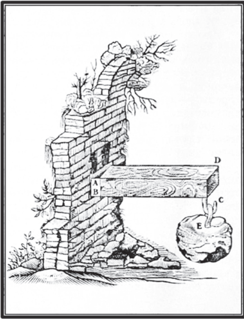
Призма ABCD, вделанная в стену; на свободный ее конец действует груз (гравюра из «Бесед» Галилея)
